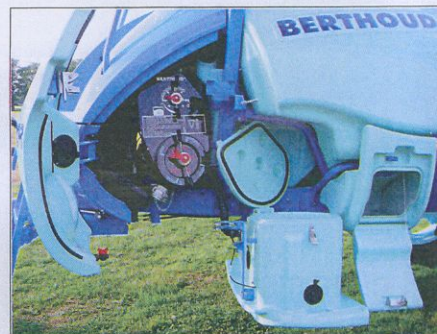
La mise en œuvre est facilitée par le regroupement des équipements comme le nouvel incorporateur de 35 l qui voisine le panneau de commandes Berlogic aux 11 fonctions facilement repérables.
