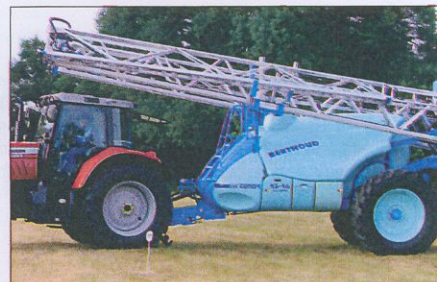
Les nouveaux Tenor de Berthoud se distinguent d'entrée par leur forme actuelle. Ils sont proposés en 4 capacités de 2 800 à 5 500 l pour des largeurs de rampe de 24 à 42 m.
