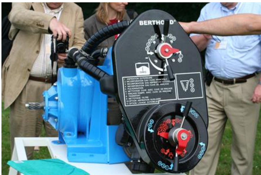
L'ensemble des fonctions de l'appareil est géré par le nouveau panneau Berlogic (© Farmerstv.com/Y.A.)
