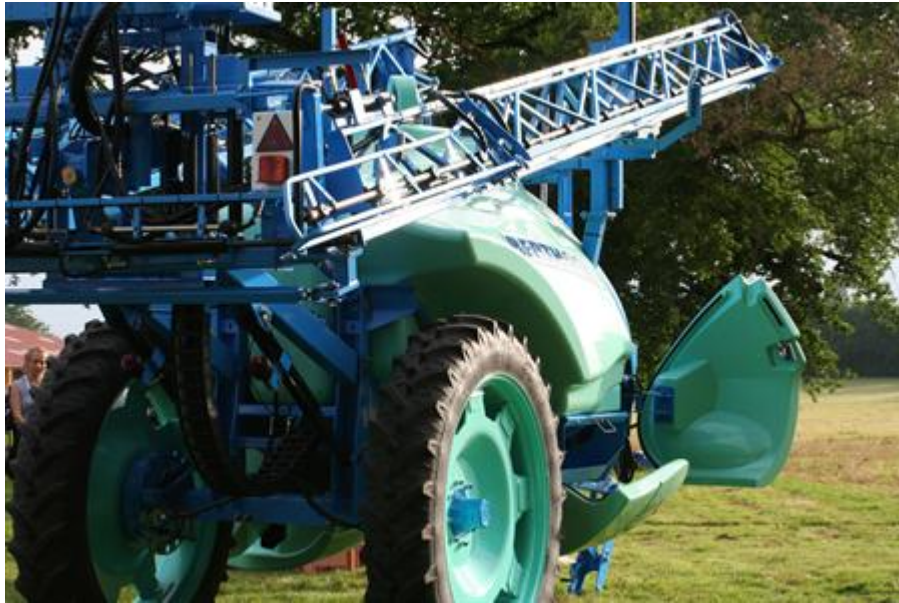
Différentes versions de rampes sont disponibles : Les rampes Axiale (24 - 28 - 30 - 32 et 33 m), les Pendulo Axiale (24 - 28 - 30 - 32 et 33) et les modèles Ektar (36 - 38 40 et 42 m). (© Farmerstv.com/ Renaud Fourreaux)
